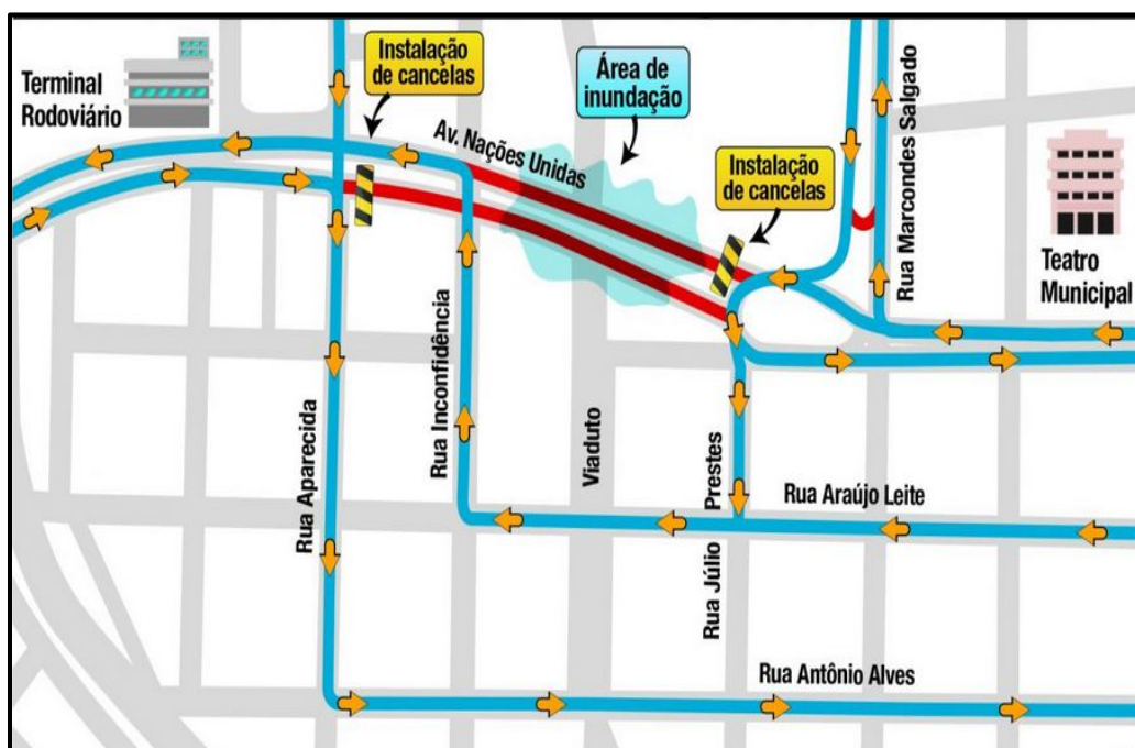
Figura 10 – Local de instalação das cancelas, e rotas de desvios em dia de chuva.
